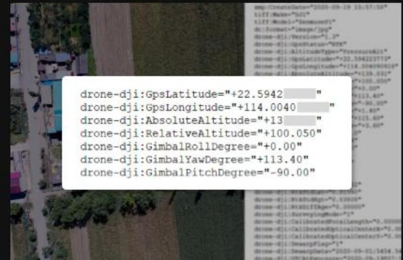
Les métadonnées de l'image comportent les paramètres intrinsèques et extrinsèques de la caméra ainsi que le statut du RTK.
